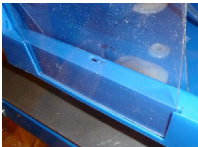
Рис. 6. Передний брызгозащитный щиток. Основная пластина вставлена в щель поддона, а малая - отведена внутрь поддона.
