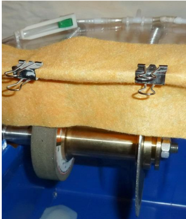
Рис.11. Нижняя часть брызгозащитной шторки должна быть направлена на оператора.
